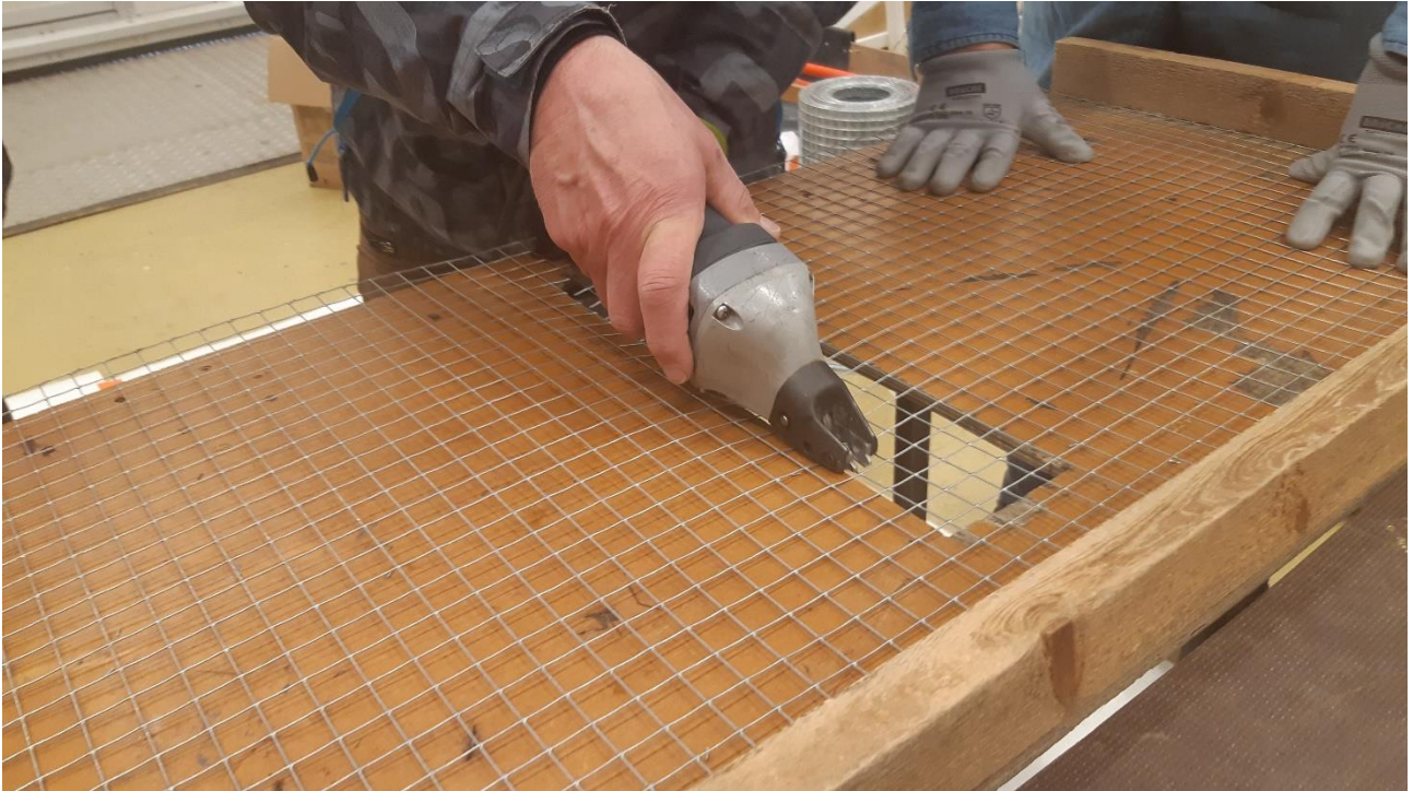
Kuva 2 Katiskan nieluaukko leikattiin paineilmakäyttöisellä työkalulla jigisapluunan mukaisesti.
