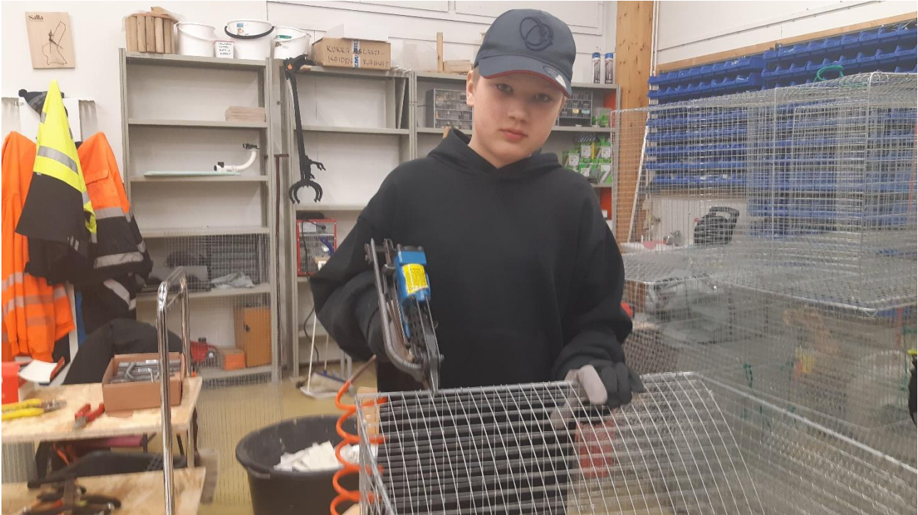
Kuva 6 ja 7. Osakaskunnan nuorta polvea edusti innokas erä- ja kalamies Julius Aatsinki. Katiskan kokoonpanovaiheessa C-renkaiden kiinnitystyökaluna paineilmatoiminen verkkositoja oli osaavissa käsissä oiva työkalu.
