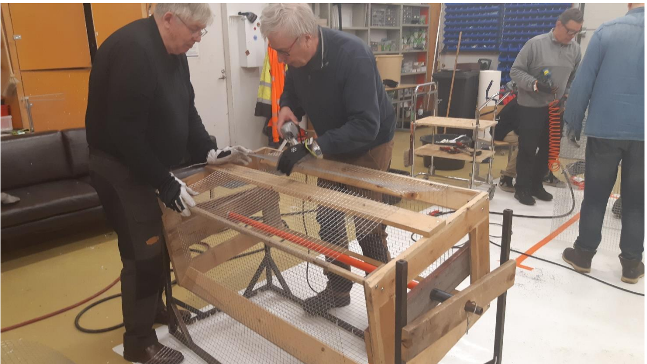
Kuva 5. Katiskan ulkokehän mittaukseen, leikkaukseen ja muotoiluun liittyvä pyörityslaite.
